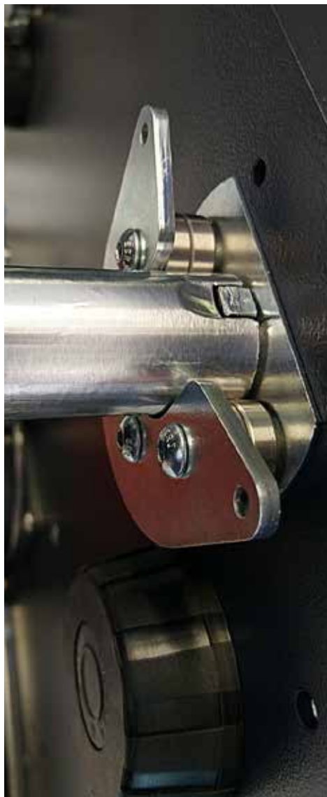
Antrieb über Bolzen-Nute-Verbindung
